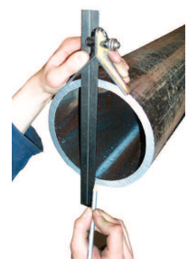
Détermination du centre d'une pièce cylindrique avec l'équerre à centrer
